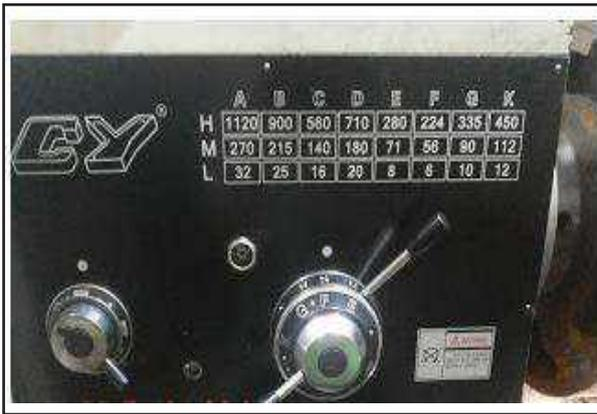
Pada proses pembubutan dengan material yang terbuat dari bahan aluminium, seorang operator mesin bubut melakukan proses pemotongan dengan menggunakan alat potong yang terbuat dari HSS. Material yang akan dikerjakan memiliki diameter  $\varnothing$  105 mm, dan kecepatan potong yang dipersyaratkan untuk jenis material tersebut adalah 5 meter/menit.
