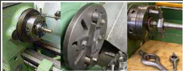
Secara prinsip proses pemesinan bubut adalah penyayatan yang dilakukan oleh alat potong yang bergerak memanjang atau melintang sumbu utama mesin terhadap benda kerja yang bergerak secara melingkar atau centrifugal.
