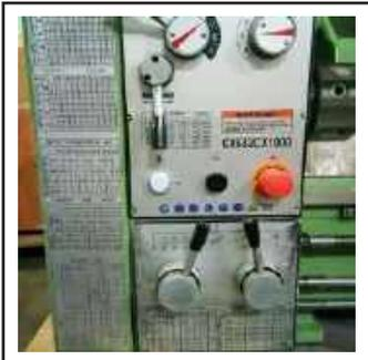
Pada proses pembubutan rata memanjang sejajar sumbu mesin, dapat kita identifikasi bahwa “untuk mendapatkan hasil penyayatan yang maksimal, seorang operator mesin bubut dianjurkan untuk menentukan kesesuaian antara kecepatan potong ( $C_s$ ) dan putaran spindle mesin ( $n$ ).”
