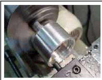
Seorang operator mesin bubut akan melaksanakan pembubutan lubang pada benda kerja yang berukuran diameter (D)  $\varnothing$  32 mm. Pembubutan lubang dilakukan dengan ketentuan diameter dalam lubang (d)  $\varnothing$  28 mm dengan kedalaman lubang adalah 50 mm. Jika mata pisau bubut dalam memiliki lebar permukaan potong sebesar 5 mm maka, di bawah ini merupakan langkah kerja yang sesuai untuk melaksanakan aktivitas pembubutan di atas adalah ?
