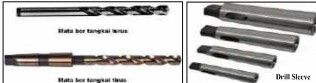
Dalam pemasangannya dapat ditambah dengan sarung pengurang (drill sleeve). Tangkai tirus pada mata bor ini menggunakan standar tirus morse atau Morse Taper (MT). Yaitu dimulai dari MT nomer 1 sampai dengan 6 untuk bagian luarnya
