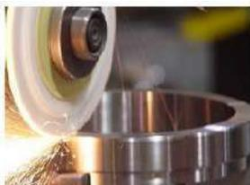
Di bagian sisi yang lain seorang siswa tertarik dengan pengerjaan profil permukaan benda. Berdasarkan pengamatan yang dilakukan oleh siswa, tercatat bahwa material yang dikerjakan oleh mesin gerinda tersebut adalah berbentuk lempengan plat tebal dengan permukaan bulat dimana bagian tepi penampang plat dibuat bertingkat (di contour) dengan kedalaman setengah dari ketebalan plat seluruhnya, seperti pada gambar di samping.
