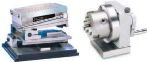
Untuk pekerjaan-pekerjaan yang memiliki tingkat kesulitan yang relatif tinggi yang disebabkan karena material kerja berbentuk bulat lurus dan berukuran kecil, industri juka melakukan pembelian perlengkapan bantu mesin gerinda yang khusus untuk pengerjaan penggerindaan rata poros-poros yang berukuran diameter kecil.
