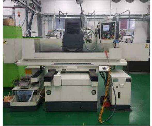
Gambar penampang mesin gerinda datar (surface grinding machine) spindle horisontal di bawah ini dipergunakan untuk menjawab pertanyaan nomor 10 sampai dengan 12
