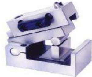
28. Salah satu macam bentuk holder khusus adalah “pembentuk sisi roda gerinda presisi” (*preccisions duples wheel dresser*) seperti pada gambar di samping.
