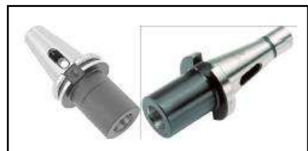
Gambar : Adaptor lubang tirus
