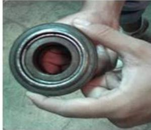
Gambar 4. Memutar release bearing dengan tangan
