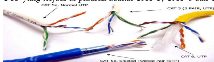
Gambar 6. Kabel UTP CAT 3, CAT 5, CAT 5e, dan CAT 6
