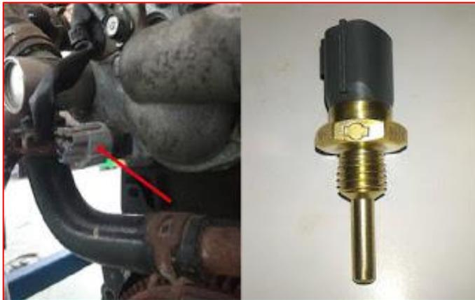
Engine Coolant Temperature Sensor berfungsi untuk mengontrol temperatur dari cairan pendingin atau air radiator pada saat kerja mesin. Sehingga temperatur air radiator akan dibaca oleh sensor Engine Coolant Temperature sebagai referensi suhu mesin.
