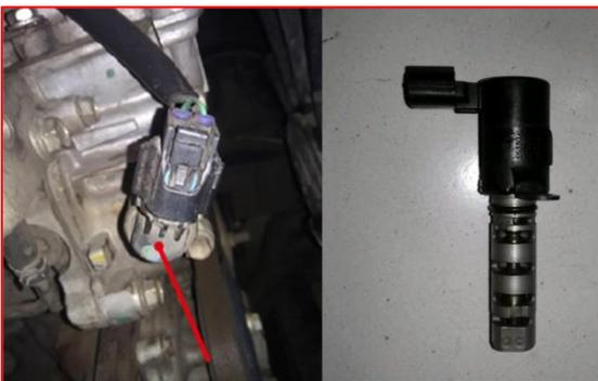
OCV bukan termasuk jenis sensor, melainkan aktuator. Oil control valve ini berfungsi untuk mengatur pembukaan katup tergantung pada tekanan oli.
