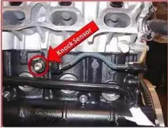
Knock sensor terbuat dari piezo electric element yang menghasilkan tegangan ketika piezo electric element-nya berubah bentuk, hal ini terjadi pada saat block silinder vibrasi yang disebabkan karena terjadinya knocking. Sensor ini terletak di block cylinder bagian kiri.
