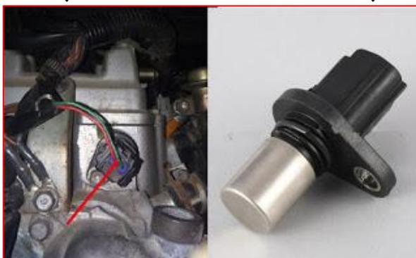
Camshaft Position Sensor (CMP Sensor) berfungsi untuk memberikan data masukan ke ECU tentang posisi langkah mesin, untuk menentukan langkah isap dimana saat langkah ini terjadi pembukaan injektor atau penginjeksian.
