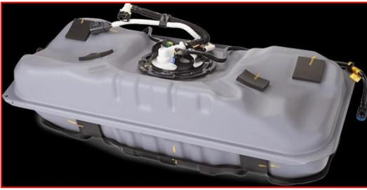
Pompa bahan bakar (*Fuel Pump*) berfungsi untuk memberikan tekanan yang sesuai agar bahan bakar dapat bersirkulasi pada system suplay bahan bakar. Pompa bahan bakar yang digunakan pada mesin yang mengaplikasikan engine management system adalah pompa elektrik yang mampu memberikan tekanan bahan bakar antara 3 sampai dengan 5 kg/cm<sup>2</sup>.
