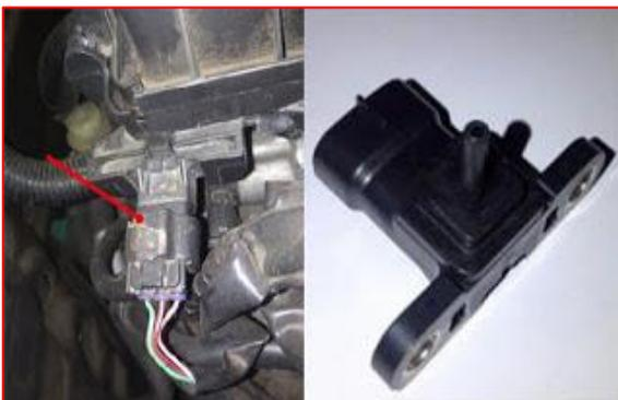
MAP berfungsi untuk mendeteksi tingkat kevacuman pada intake manifold setelah throttle body yang diakibatkan isapan dari mesin. Sensor ini sering disebut juga sebagai sensor vakum, karena fungsinya memang untuk membaca tekanan atau kevakuman. Pada mesin tipe D-EFI sensor ini terletak di sebelah kiri di rumah filter udara.
