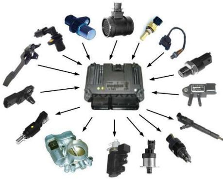
*Engine management system* (EMS) adalah salah satu bagian penting dari mesin EFI. *Engine management system* adalah sistem pengaturan engine yang mengatur dan mengontrol seluruh sistem pada engine melalui *electronic control unit* (ECU) sehingga engine atau mesin dalam kondisi serta performa terbaik.
