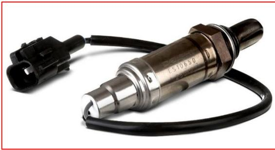
O2 sensor / Oxygen Sensor adalah sensor gas buang, sensor oksigen berfungsi untuk mengukur kadar oksigen pada gas buang, kadar oksigen ini akan menunjukkan tingkat emisi yang dihasilkan mesin. Dari kadar oksigen pada gas buang inilah
