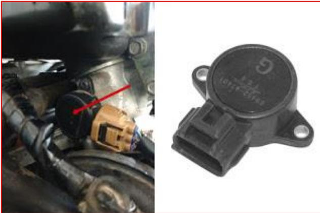
Throttle Position Sensor berfungsi untuk memantau posisi throttle apakah terbuka sebagian, terbuka penuh atau tertutup, dan untuk mengetahui berapa persen (%) katup gas (throttle valve) dibuka atau seberapa lebar katup gas terbuka saat pedal gas diinjak.
