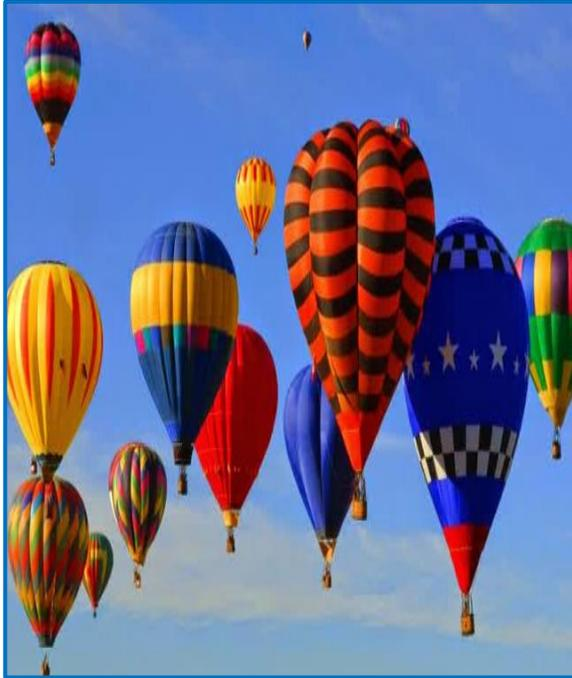
✚ Cara kerja balon udara sangat sederhana yaitu dengan cara memanaskan udara di dalam balon agar lebih panas dari udara di luarnya sehingga balon udara mengembang dan dapat naik (terbang). Udara yang lebih panas akan lebih ringan karena masa per unit volumenya lebih sedikit.
