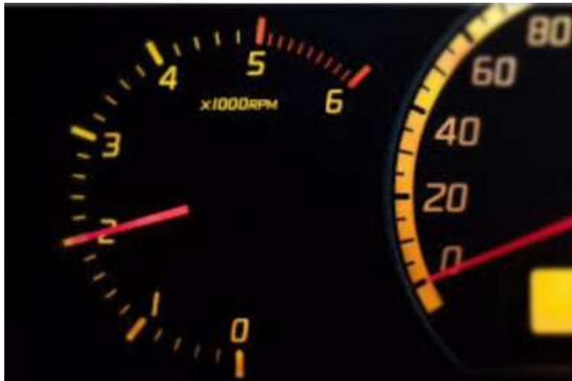
Gambar 8. Putaran Idle Mesin Terlalu Tinggi
