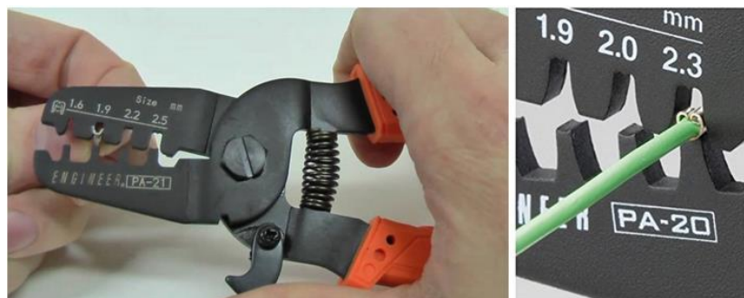
Gambar 40. Cara penggunaan tang pengepres sepatu kabel
