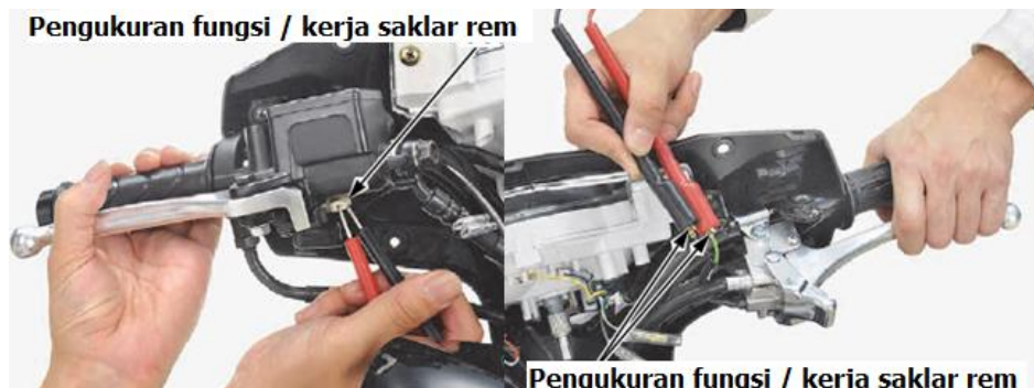
Gambar 16. Pengukuran fungsi/kerja saklar rem depan dan belakang
