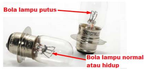
Gambar 48. Pemeriksaan kondisi filamen bola lampu
