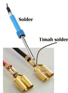
Gambar 37. Penyolderan sepatu kabel
