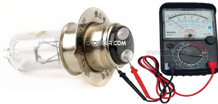
Gambar 49. Pemeriksaan hubungan/kontinuitas antara filamen dan massa
