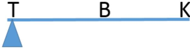
Contoh : gerobak beroda satu, alat pemotong kertas, dan alat pemecah kemiri, pembuka tutup botol
