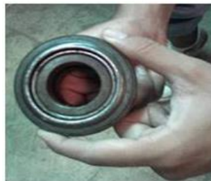
Gambar 4. Memutar release bearing dengan tangan
