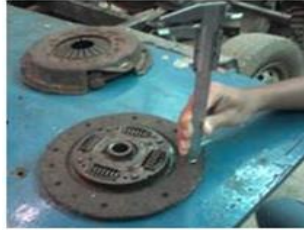
Gambar 2. Mengukur kedalaman kepala paku keling
