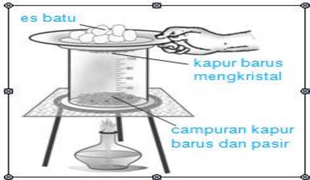
Gambar Proses pemisahan campuran dengan subliminasi
