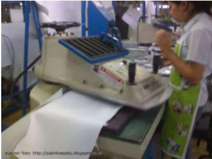
*Gambar a: Foto proses pemotongan bahan dengan mesin sebagai bahan dasar sepatu*
