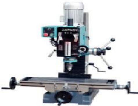
Gambar Mesin frais vertikal
