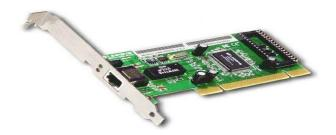
Modem internal adalah perangkat jaringan yang terdapat pada papan ekspansi yang dihubungkan ke motherboard. Perangkat ini sering juga disebut dengan Land Card ( Kartu Jaringan ) yang ditanam pada Mother Board komputer.
