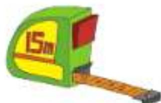
Meteran gulung disebut juga meteran saku. Meteran gulung berfungsi untuk mengukur panjang benda yang lebih dari satu meter. Meteran ini biasa digunakan pekerja bangunan atau tukang kayu.
