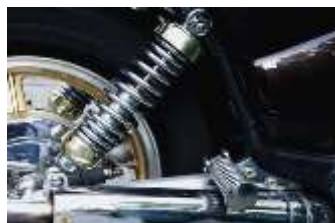
Gambar 8 Peredam kejut (shock absorber) pada motor
