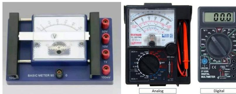
Gambar 1. Volt meter, AVO meter analog dan digital.
