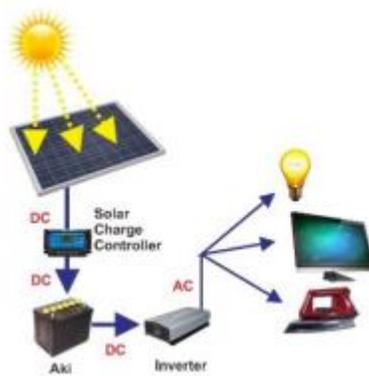
Lakukan analisis kelebihan panel surya sebagai pembangkit listrik tenaga surya dibandingkan pembangkit tenaga lainnya, lengkapi jawabanmu dengan bukti!
